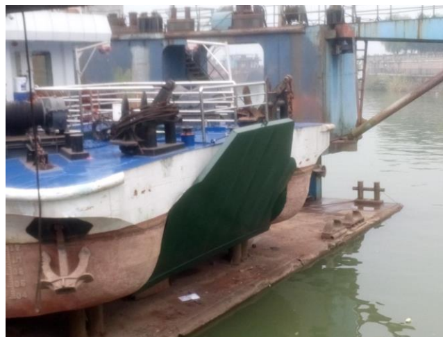
船艏安装挡水板
